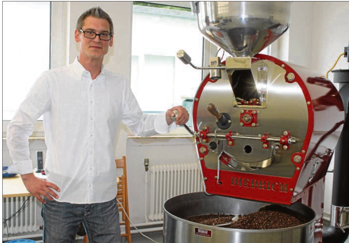
Michael Schmidt vor seinem Trommelröster. 17 bis 20 Minuten bleiben die Kaffeebohnen in dem Gerät, das beim Röstvorgang eine Temperatur von rund 200 bis 240 Grad erzeugt. Industrielle Röster heizen die Bohnen bis auf 600 Grad auf. ■ Foto: Schwarz
